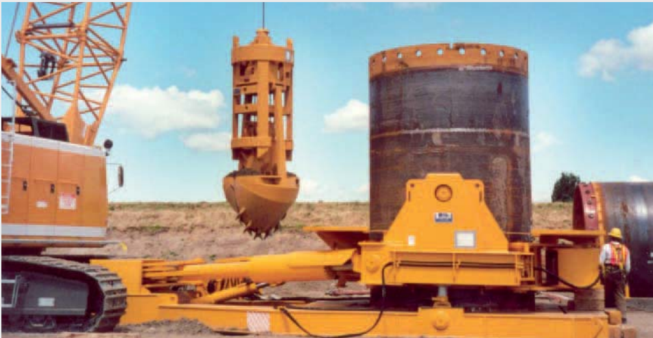
Verrohrungsmaschine \varnothing 3000 mm im Einsatz in den USA Hydraulic casing oscillator, \varnothing = 3000 mm in operation in the USA
