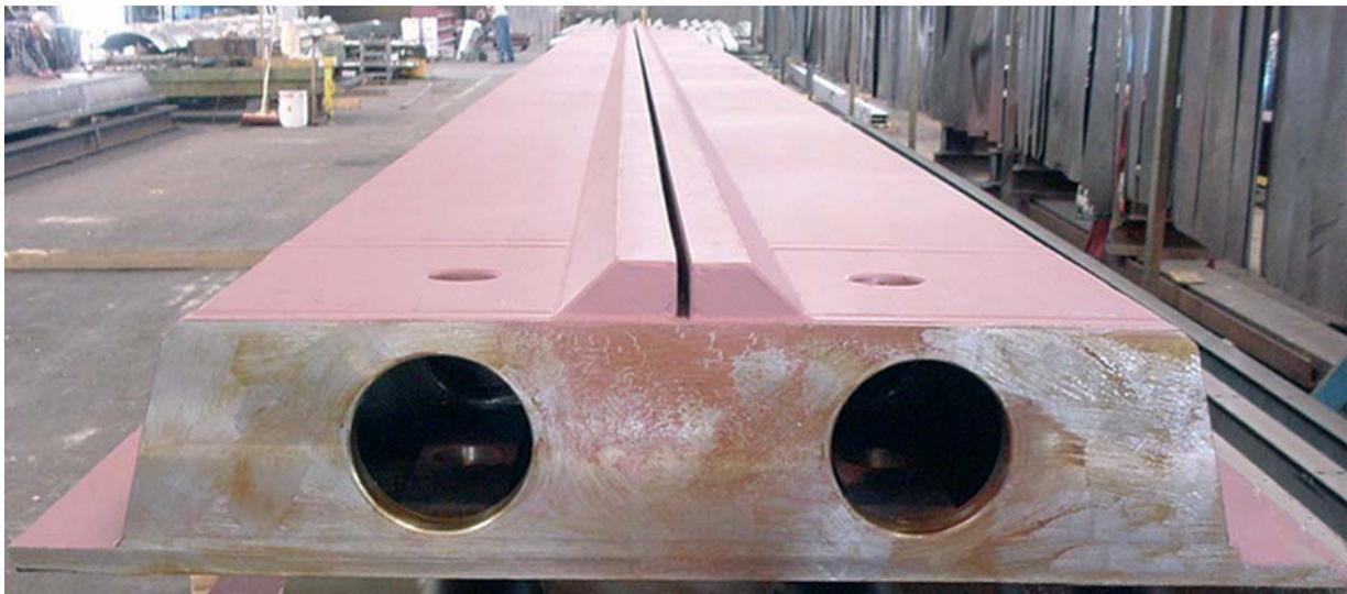
Bei der Herstellung von Ortbetonschlitzwänden spielt die Verwendung der richtigen Abschalelemente, besonders im Hinblick auf Wasserdichtigkeit, eine enorm wichtige Rolle.
